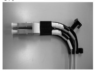
⑤ダストキャップをはずし、保護ホルダ装着済の コネクタをユニットの O U T 側 (下) に「カチッ」 と音がするまで押し込んでください。
