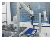
外観検査を行い、ワークの良否判定
