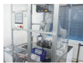
エンドエフェクタでワークを吸着、トレイへ搬出
