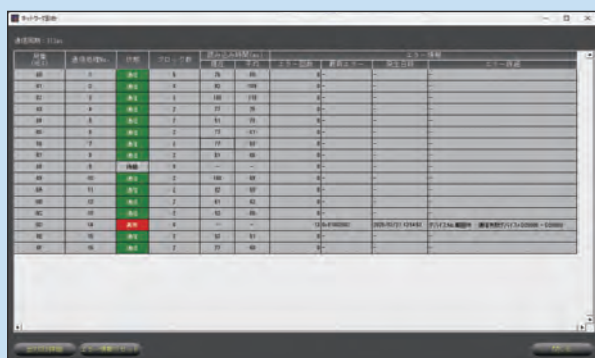
各シーケンサとの接続状態、通信サイクル、ネットワーク上のエラー・発生状況の表示 (最大8画面)
