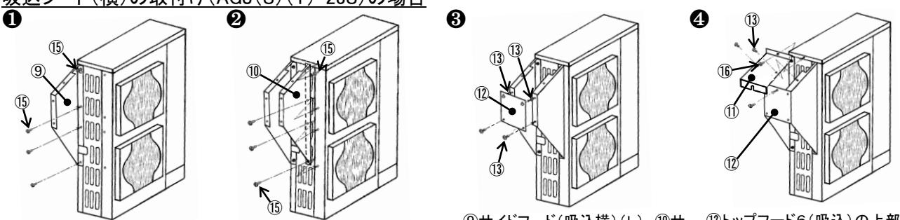
室外ユニットの一番上の取付穴に⑯タッピングネジをねじ長の半分の位置まで回し込み、⑨サイドフード(吸込横)(L)のダルマ穴位置で引掛け、ネジを締込む。残りの取付穴には⑮タッピングネジで取付ける。
