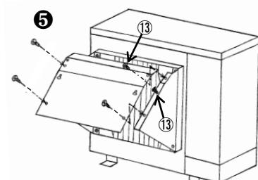
④で取付けた⑬タッピングネジに③トップフード1(吹出)のダルマ穴位置で引掛け、ネジを締込む。
