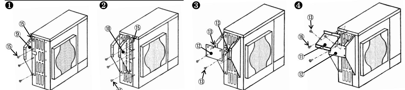
室外ユニットの一番上の取付穴に⑯タッピンネジをネジ長の半分の位置まで回し込み、⑨サイドフード(吸込横)(L)のダルマ穴位置で引掛け、ネジを締込む。残りの取付穴には⑯タッピンネジで取付ける。
