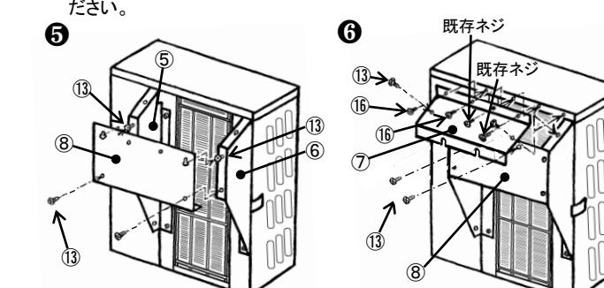
⑤サイドフード(吸込後)(L)、⑥サイドフード(吸込後)(R)の上部穴に⑯タッピングネジをねじ長の半分の位置まで回し込み、⑦トップフード3(吸込)のU字切欠き部で引掛け、ネジを締込む。
