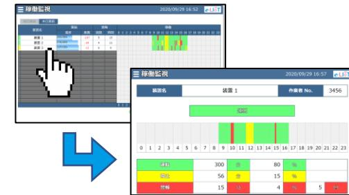
装置の稼働状態の推移をタイムチャートとしてグラフ表示します。設備名称をクリックすると設備稼働状態の詳細グラフを表示します。
