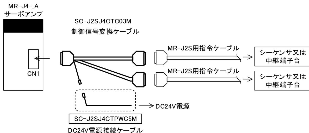
※置換え後の SC-J2SJ4CTPWC5M(DC24V 電源接続ケーブル)は、置換え前の MR-J2S の際に DC24V 内部電源を使用されていた場合に接続してください。接続の無い場合、電源投入すると『AL. E6\_』(非常停止)が発生します。
