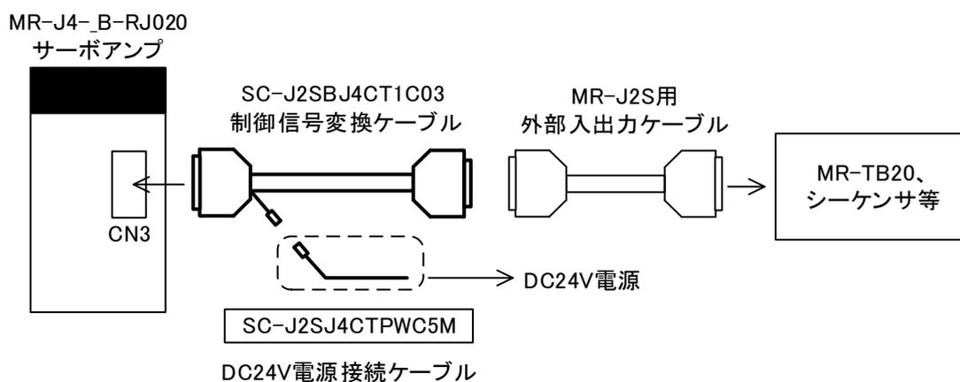
※置換え後の SC-J2SJ4CTPWC5M(DC24V 電源接続ケーブル)は、置換え前の MR-J2S の際に DC24V 内部電源を使用されていた場合に接続してください。接続の無い場合、電源投入すると『AL.E6』(非常停止)が発生します。
