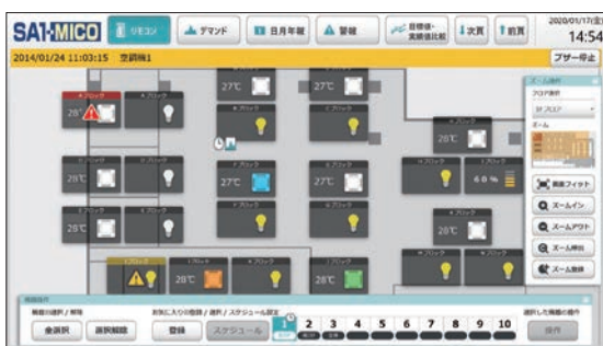
照明・空調統合操作画面
