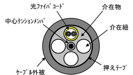
図. 光ケーブル構造
