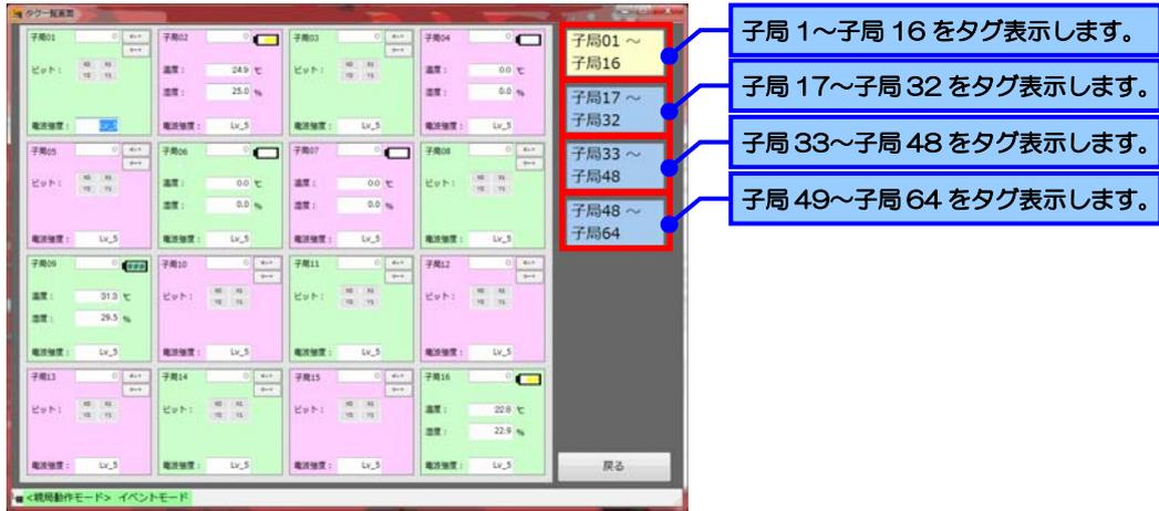
子局 1～16 のタグ表示中に「子局 17～子局 32」ボタンをクリックすると、子局 17～32 のタグ表示画面に移行します。
