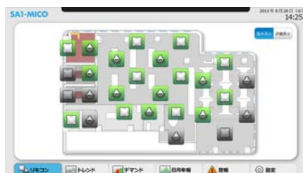
照明・空調統合操作画面
