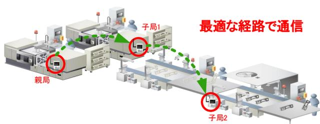
簡易自動経路更新機能:全無線ユニット間の電波レベルを測定し、より安定する経路を選定し、更新します。
